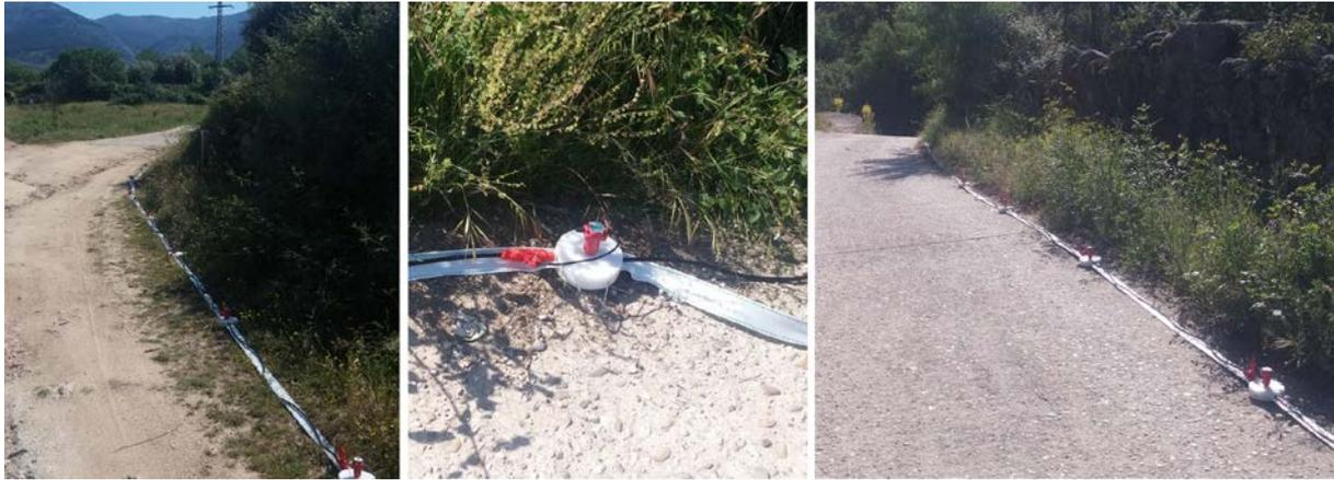
Figura 8: Trazado de uno de los perfiles de investigación y del equipo de registro.
